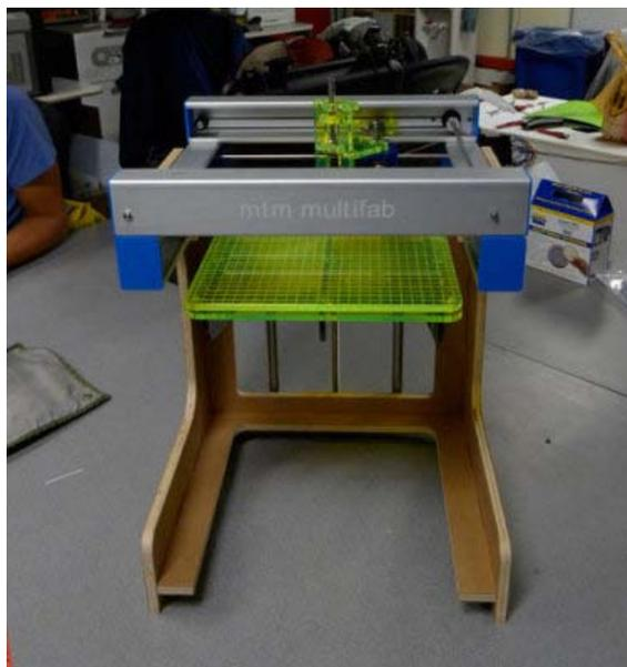
Der "Multifab" zeichnet sich durch Vielseitigkeit aus: Je nach Arbeitskopf wird aus dem Gerät ein Fräse, ein Plotter oder ein Pipettierroboter.
